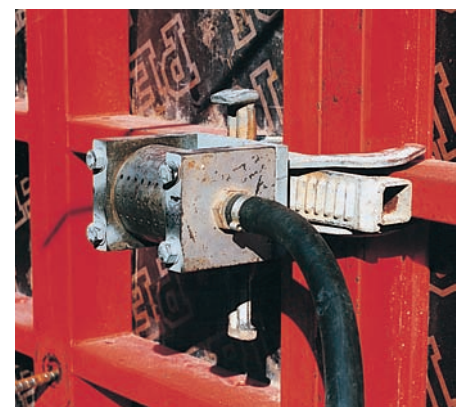
Σύνδεση εξωτερικών δονητών
